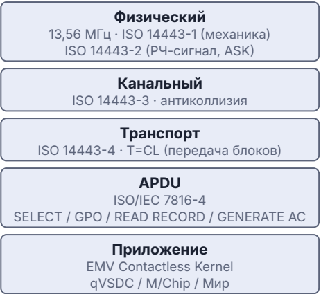
Рис. 21 — Стек протоколов бесконтактного платежа и анатомия APDU-команд.
